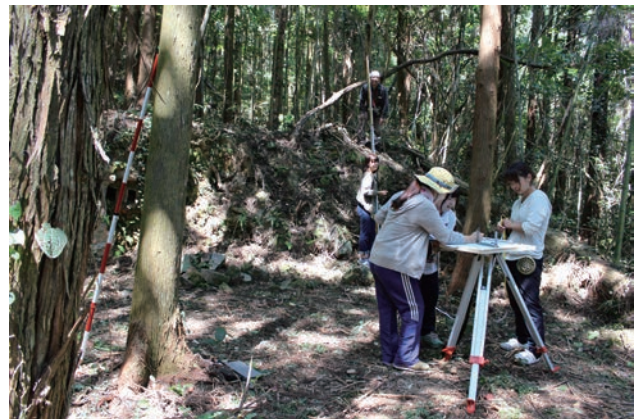
図 15 田ノ江窯跡測量風景（平板測量）
