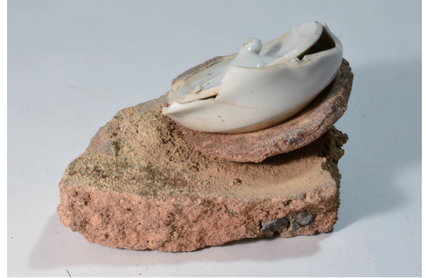
写真 20 急須とハマA類が熔着したサヤ底
