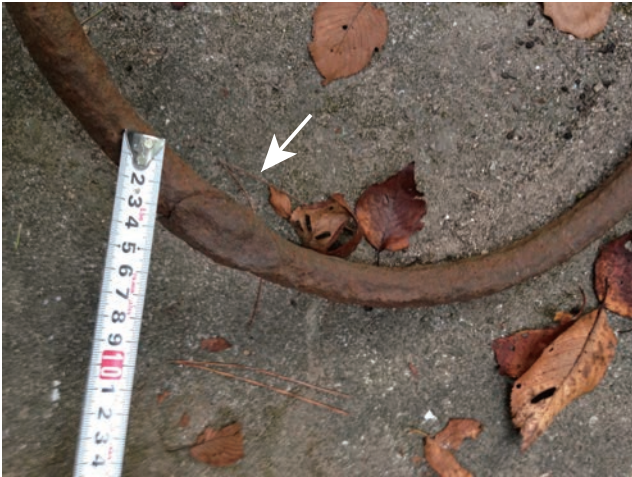
図 9. AR/II 類の製造時の痕跡 (尾道市千光寺階段下 (AcR/II A-1 類)、筆者撮影)
