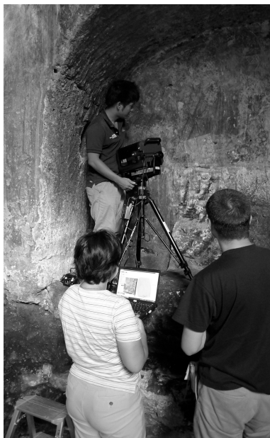
レーザー・スキャンによるミクロン単位での壁画スキャン
