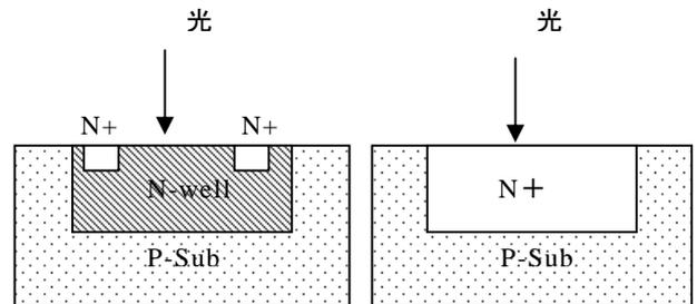
図 4 (a)PSub/Nwell 構造 (b)PSub/Ndiff 構造
