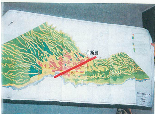
写真-5 アルメニア市の被害分布 3) （赤色の帯の部分の被害が甚大であった）
