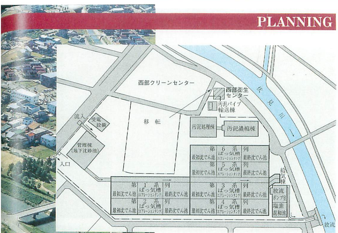
図-2 水質管理センター施設配置 (水処理系はすべて地下施設)
