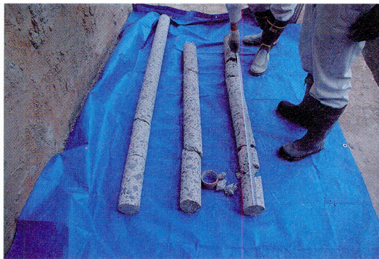
写真-4 鉛直コアの採取状況
