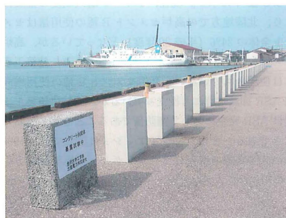
写真-1 富山新港での鉄筋コンクリート試験体の暴露状況
