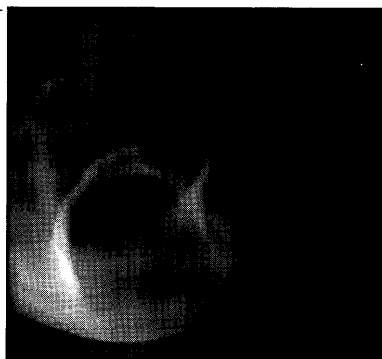
図5 ヘリオトロンJにおいてCCDカメラで接線方向から観測した初期プラズマ, (a)第2高調波ECHと(b)基本波ECH.
