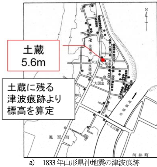
図-17 定点における既往最大津波痕跡高と解析結果の比較 (輪島市鳳至町)
