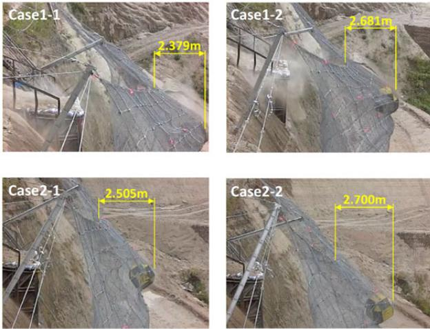
写真-5 金網最大変形量(上:従来型金網,下:新型金網)
