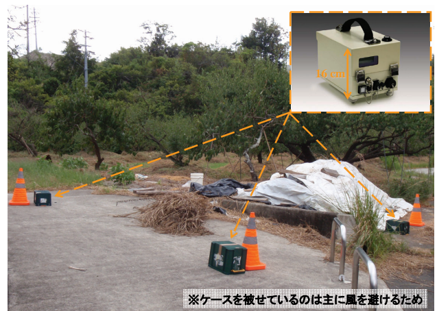
写真-4 微動アレー探査実施状況と採用した微動計
