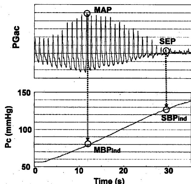
図2 本システムによる容積振動法実施時の記録波形例。PGac:光電容積脈波、Pc:大腿部圧迫圧力(心臓位置に補正済み)
