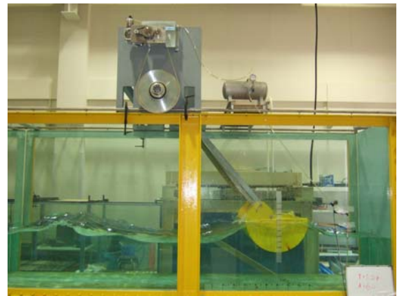
図-2 浮体式波エネルギー吸収装置
