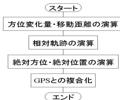
図 4: 推測航法のメインルーチンの演算処理
