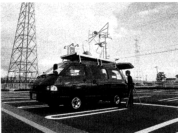
図2 電磁波環境の移動観測用自動車
